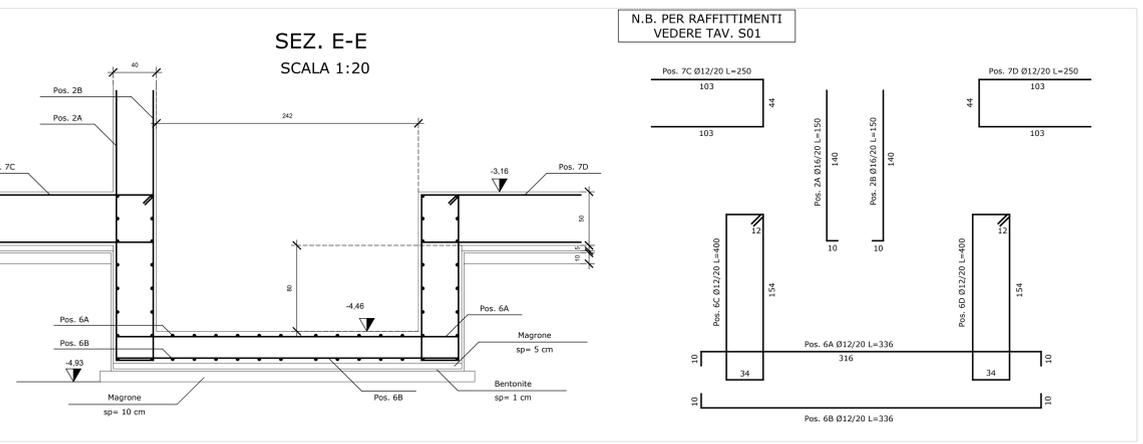
N. B. Nel piano indicato andranno realizzate tutte le formetrie necessarie per il passaggio delle tubazioni degli impianti congruenti con l'elaborato M03. Le stesse andranno verificate in contraddittorio tra Direzione Lavori e Impresa.
