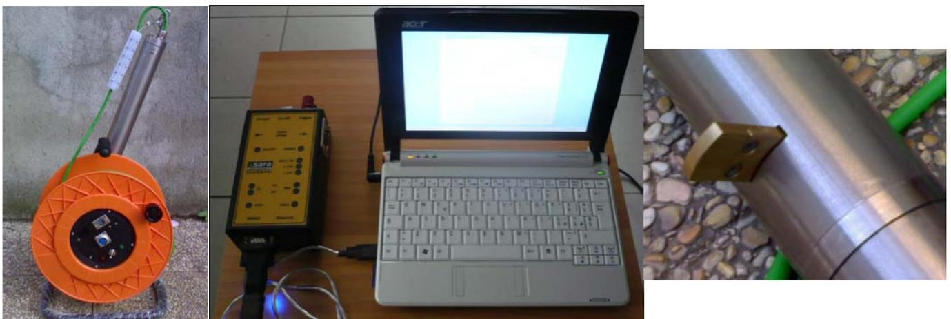
Strumentazione utilizzata per acquisizione sismica Down\_Hole. A sinistra il sensore SS-BH, al centro l'interfaccia master, a destra particolare del dispositivo di ancoraggio.
